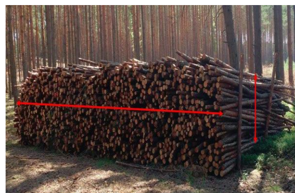
Ryc. 16. Pomiar przeciętnej szerokości w stosie S3A i M1 zabezpieczonym palikami. Pomiar wysokości w połowie długości
