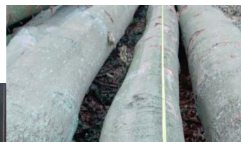
Ryc. 8. Drewno S2A ułożone w stos z legarami uniesionymi skośnie do podłoża, w kształcie „kołyski”
