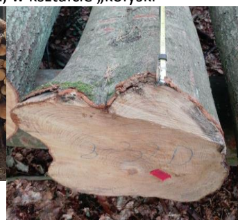
Ryc. 9. Pomiar długości sztuki drewna z pominięciem razu podcinającego
